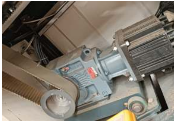
HASSAS VE GÜÇLÜ SERVO TAHRİK SİSTEMİ / High power and precision servo motor and gear box
